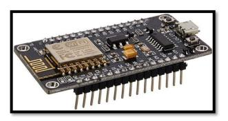
Fig-1: NodeMCU ESP8266
